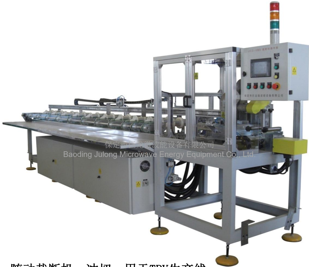
随动裁断机，冲切，用于TPV生产线
