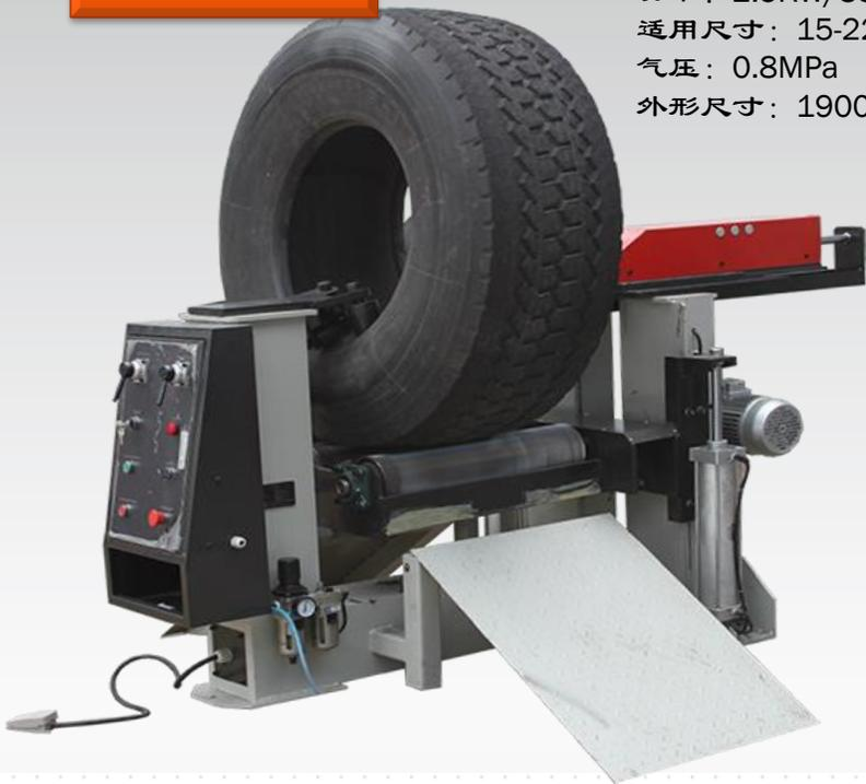
本设备是对轮胎进行检验的设备。将待检验的轮胎放置在扩胎检验机上，扩胎检验机会将轮胎扩张到适合检验的宽度，然后人为的对轮胎进行检验。在整个检验过程中，轮胎的扩张宽度、检验高度可以任意调节，轮胎可以自动旋转，并且可以随时停止，便于操作人员的检验，从而提高了检测效率。
