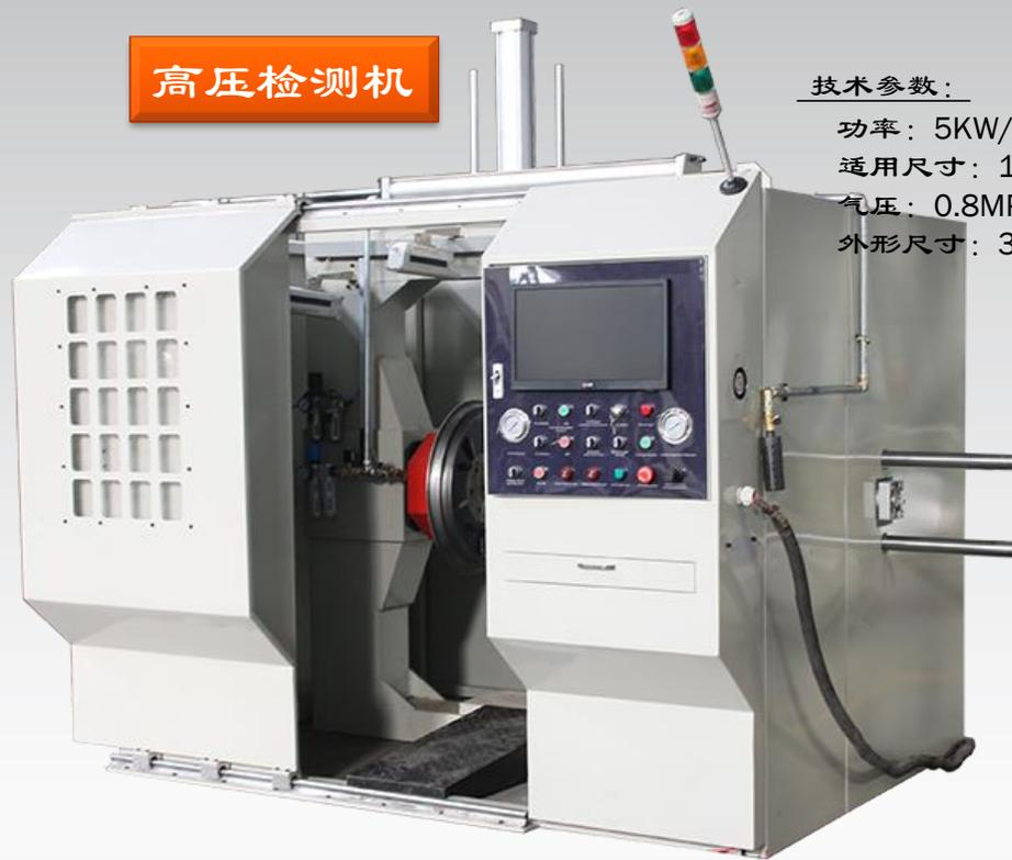
高压检测机可以用来检测轮胎是否已经达到正常的路况行驶要求。可以确保轮胎已经具有很高的品质，符合正常路况行驶的要求。最高充气压力可以达到16Kgf/cm<sup>2</sup>。适用于15"-22.5"的轮胎。充气压力和检测时间由工控机来控制，所有数据由触摸屏进行输入，确保充气压力和检测时间的检测精度。有三个高清摄像头实时监控轮胎的三个表面在检测过程中的变化。充气压力和检测时间的曲线被存储在电脑中，可以随时被调用、查看、打印。监控的数据也被存储在电脑中，并且与每一条轮胎一一对应，随时可以根据轮胎编号进行调用。
