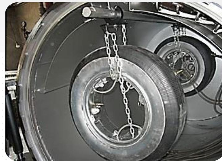
包封套钢圈内胎安装图
