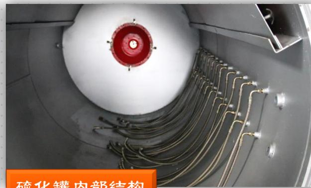
硫化罐内部结构
