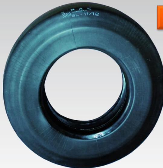
在硫化过程中，用于隔离轮胎预硫化罐的压力空气直接接触，防止在未硫化时，硫化罐内的压缩空气进入胎面胶与胎体间的缝隙。最高工作温度可以达到130℃，使用寿命超过500小时。
