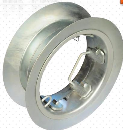
在硫化过程中，用于将包封套的两边紧密的压合在轮胎两侧，并且对硫化内胎起到支撑作用，双包封套系统不需要使用硫化钢圈。由16Mn弹簧钢一次冲压成型，可以保证使用过程中不发生变形。标准规格有：10"、12"、13"、14"、15"、16"、17.5"、18"、19.5"、20"、21"、22.5"、24"、25"等规格，可以根据客户要求定制。
