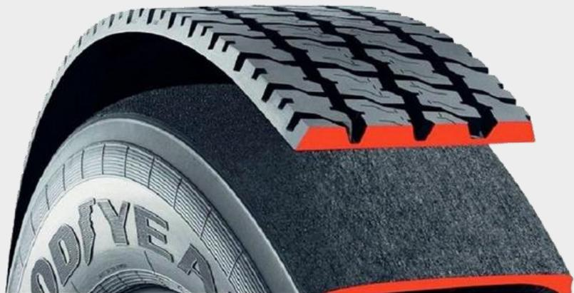
轮胎翻新过程中贴在轮胎表面的全新的花纹橡胶，具有高度的耐磨性、耐疲劳性能，良好的耐老化性能，较高的拉伸强度、弹性和强韧性，以及行驶时低的生热性。
